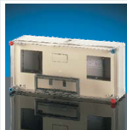
600x300 mm Basic 11fmK-F cikksz.: HB11KF mérőkombináció 2 egyfázisú fogyasztásmérő, hangfrekvenciás vevő (ELMŰ, ÉMÁSZ) vagy rádiófrekvenciás vevő (EON) számára, fővezetési sorkapocs nélkül, beépítési mélység: max. 146 mm
