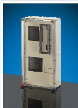
300x600 mm Basic 11fmK-A cikksz.: HB11KA mérőkombináció 2 egyfázisú fogyasztásmérő, hangfrekvenciás vevő (ELMŰ, ÉMÁSZ) vagy rádiófrekvenciás vevő (EON) számára, fővezetési sorkapocs nélkül, beépítési mélység: max. 146 mm
