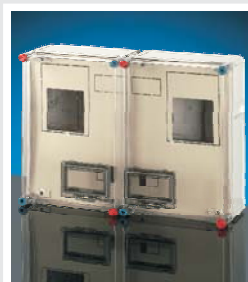
600x450 mm Basic 33fmK cikksz.: HB33K0 mérőkombináció általános és vezérelt fogyasztásmérő és vezérlőkészülékek számára, 2x3, vagy 2x1 fázisú alkalmazásra, fővezetési sorkapocs nélkül, beépítési mélység: max. 146 mm
